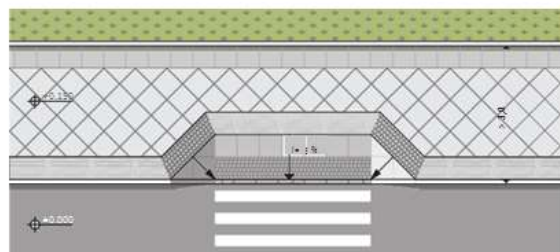
Схема 3-2. Пример организации предупреждающих покрытий при помощи изменения цвета, фактуры и типа укладки
