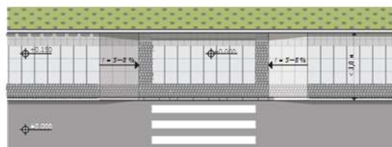
Схема 4-2. Пример организации предупреждающих покрытий при помощи изменения цвета, фактуры и типа укладки
