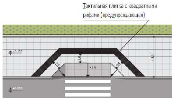
Схема 3. Наземный пешеходный переход. Ширина пешеходного тротуара — более 3,0 м. Размещение тактильных указателей
