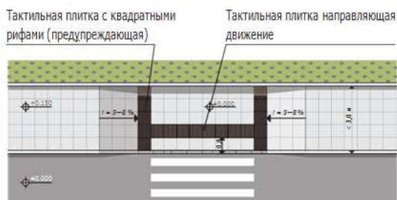
Схема 4. Наземный пешеходный переход, расположенный перпендикулярно движению пешехода на ограниченной территории. Ширина пешеходного тротуара — менее 3,0 м.
